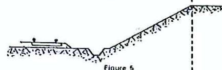
Dans le cas d'une voie posée à flanc de coteau, la limite légale à considérer est constituée par le point extrême des déblais ou remblais effectués pour la construction de la ligne et non la limite du talus naturel (figures 6 et 7)
